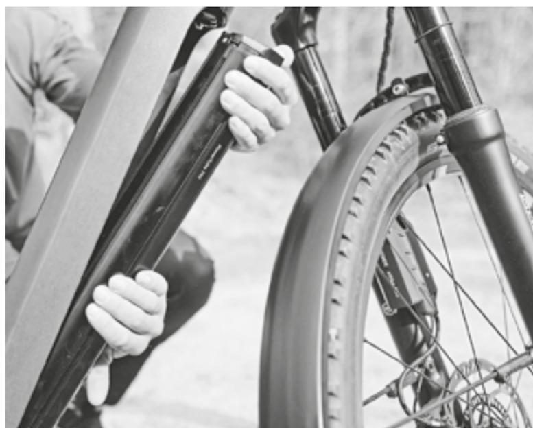
mit einem Batterie-Management-System ausgestattet: Es überwacht die Batterie fortwährend, erkennt kritische Betriebszustände und schützt die Zellen vor Überlastung. Erkennt das System ein Problem, schaltet es den Akku automatisch zum Schutz des E-Bikers ab. Beim Fahrradfachhändler können
